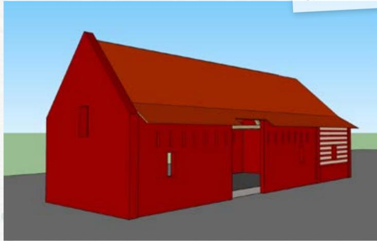
Le premier scénario propose de restaurer les murs gouttereaux en brique de 22 cm, sans l'ossature bois. Les panneaux solaires, la verrière et la terrasse Nord sont chiffrés en option.
