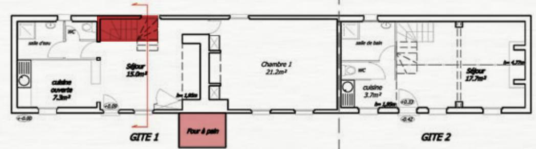
La création d'un escalier dans l'angle nord-ouest, dans le gîte 1 donnera accès à l'étage, aménagé en chambre mansardée. Cet escalier est éclairé grâce au percement d'un oculus, identique à celui existant.
